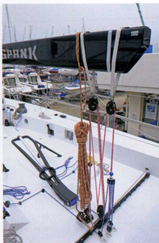
ブームとティラーはツボキヨットによるカーボン製。ラダーシャフトまわりの慣性やフリクションは非常に小さい。残念ながらツボキヨットは6月に廃業したため、ACT GP33は新たな造船所を探している
