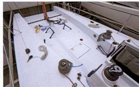
上:キールライン(バトック)、水線面(ウオーターライン)とも、ホロー(へこみ)を持つ独特のステム下部形状が特徴 左:バングなどを含むメインセール関係のコントロールは、ヘルムスマンより後ろに位置したメインセールトリマーが一人で行えるようになっている
