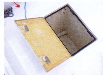
クラスルールで定められている、コクピットフロアのライフラフト格納スペース。ハッチは色こそ塗ってあるがバウハッチと同じ構造で、非常に軽い
