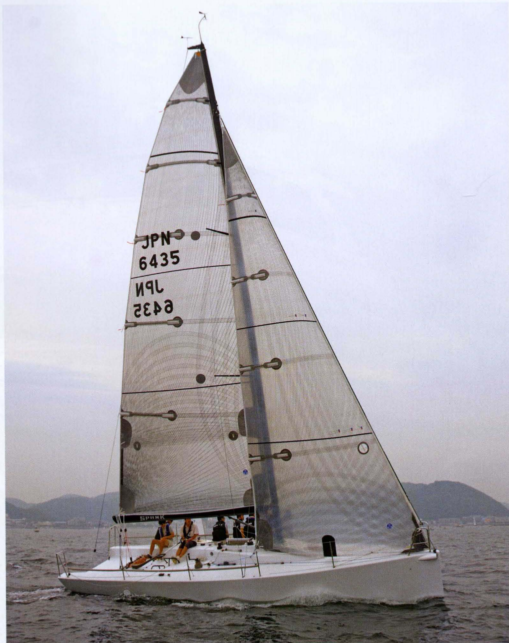
GP33のリグはややポイントが低く、メインセイルが大きいことが特徴。IRC対応としてはメインセイルのエリア調整も考えるとのこと
