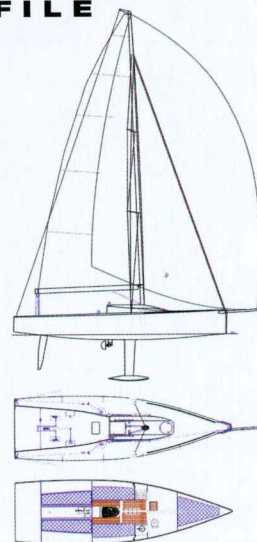
GP33のリグはややポイントが低く、メインセイルが大きいことが特徴。IRC対応としてはメインセイルのエリア調整も考えるとのこと
