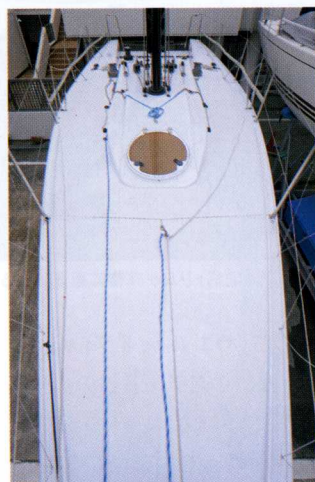
バウハッチは、ハニカムの心材を色付けなしに積層しただけのもの。シンプルで軽く、さらに採光もできるという優れもの
