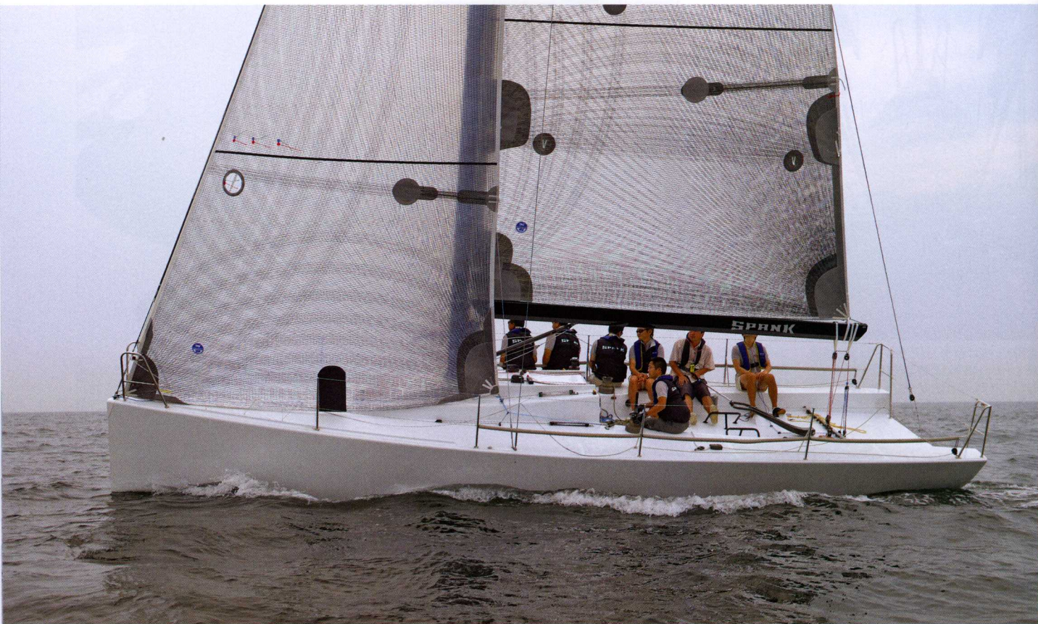
ステム下端がわずかに水に入るセーリング状態。GP33クラスはただでさえ軽いので、〈スパンク〉では前後トリムが非常に重要になる
