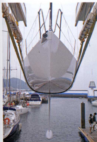
台形といえば台形だが、ビルジは丸みを帯びており、〈CF〉ほど箱型ではない。それにしても、ハルの仕上げは見事だ
